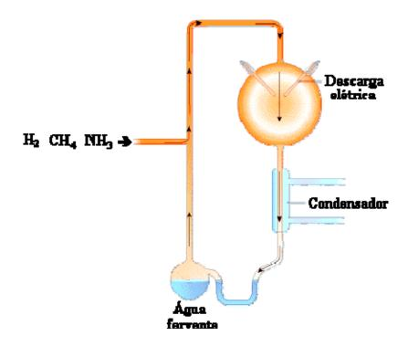
Num certo lugar do aparelho, a mistura era submetida a descargas elétricas constantes, simulando os "raios" das tempestades que se acredita terem existido na época. Um pouco adiante, a mistura era esfriada e, ocorrendo condensação, tornava-se novamente líquida. Ao fim da semana, a água do reservatório, analisada pelo método da cromatografia, mostrou a presença de muitas moléculas orgânicas, entre as quais alguns aminoácidos.
